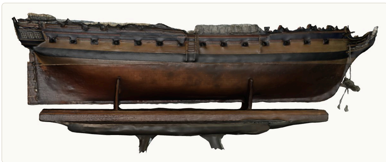
Poging 1: binnen onder lampen, 221 foto's van een meter afstand. De romp is vlekkerig, de verschansing is pap.
